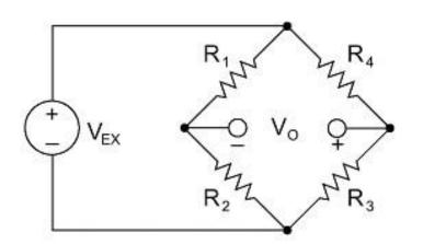
$$V_o = V_i \left[ \frac{R_3}{R_3 + R_4} - \frac{R_2}{R_1 + R_2} \right]$$
